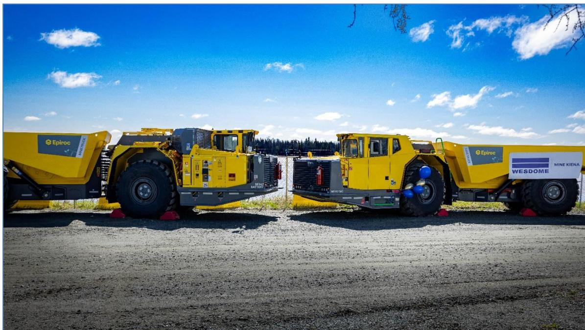
*Nos deux camions électriques à batterie Minetruck MT42 SG*
